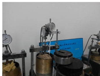
图 1 改装后的单向固结仪 Fig.1 Modified oedometer
